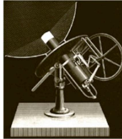
1872 – rappresentazione del - primo - motore ad aria con concentratore puntuale
